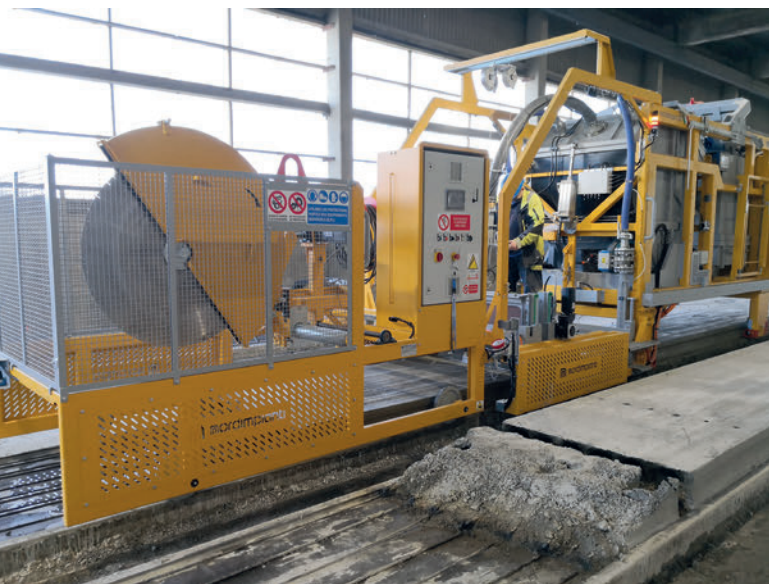
Sierra de hormigón automática combinada con la aspiradora de hormigón
