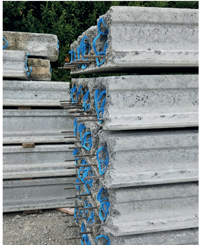
Placas alveolares pretensadas con alambres pretensados al aire
